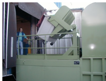
Chargement par basculeur à quai
