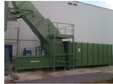
Chargement par goulotte extérieure
